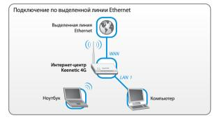
При организации домашней сети вы можете использовать встроенную точку доступа и два разъема «LAN». Каждое устройство домашней сети должно быть оборудовано сетевым адаптером Wi-Fi или Ethernet. Интернет-центр по протоколу DHCP автоматически назначит параметры IP всем подключенным устройствам. Общие рекомендации по работе в беспроводной сети приведены на *стр. 24*.
