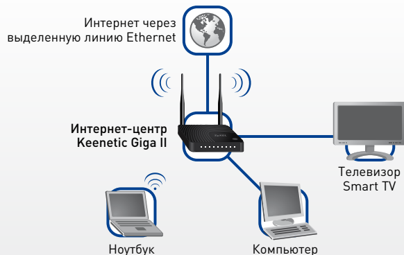
Подключение по выделенной линии Ethernet
