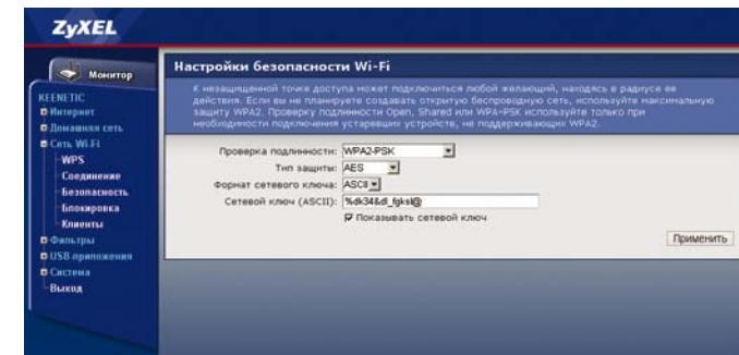
Для подключения WPS-совместимых устройств к беспроводной сети интернет-центра можно воспользоваться функцией автоматической настройки Wi-Fi (WPS), для остальных потребуется самостоятельно выполнить настройку и указать ключ беспроводной сети.
