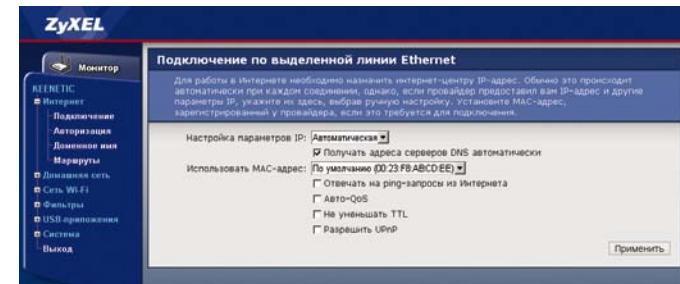
В этом же окне измените MAC-адрес, используемый интернет-центром по умолчанию, если в договоре с провайдером указан MAC-адрес другого устройства, например вашего компьютера.
