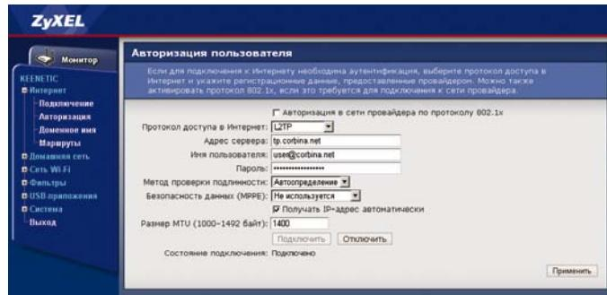
Если провайдер использует протокол 802.1x, установите флагок «Авторизация в сети провайдера по протоколу 802.1x», выберите из списка метод проверки подлинности и укажите имя пользователя с паролем.
