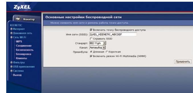
В соответствии с возможностями ваших беспроводных устройств выберите из списка стандарт сети. Если вы планируете подключать к сети устройства стандартов 802.11g и 802.11n, выберите вариант 802.11g/n.
