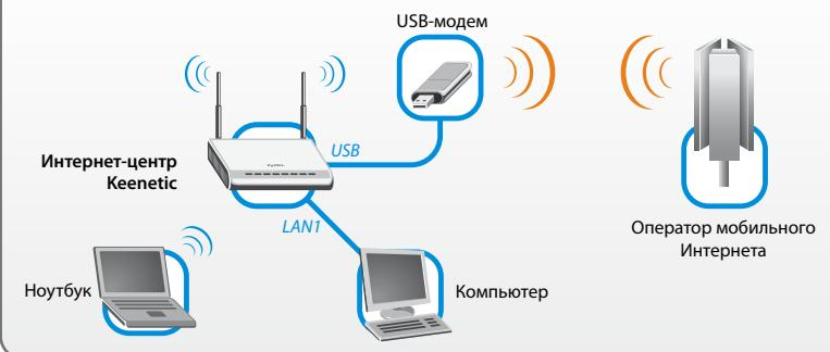
Выбрав в веб-конфигураторе режим подключения к Интернету через USB-модем 3G или 4G, для организации домашней сети вы можете использовать встроенную точку беспроводного доступа, разъем «WAN» и четыре разъема «LAN» — независимо от того, установлено соединение с мобильным Интернетом или нет.
