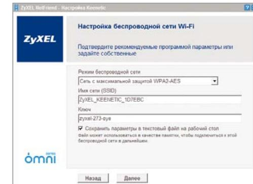
Чтобы не забыть установленные параметры беспроводной сети, можно сохранить их в текстовый файл на рабочем столе Windows.
