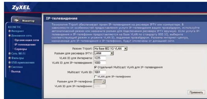
**Важно:** Разъемы, выбранные для подключения ресивера IPTV и IP-телефона, будут отключены от остальной домашней сети.
