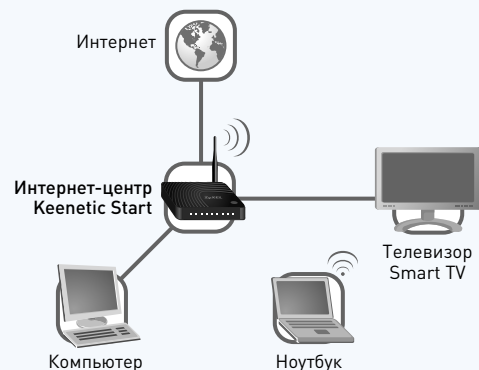
Подключение по выделенной линии Ethernet
